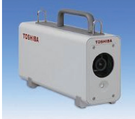
東芝製の「ガンマカメラ」は、福島原子力発電所の建屋内調査のために使用されていたが、同社独自の半導体検出素子の実装技術や、信号処理・データ処理技術により、感度・測定性能を三十倍以上高め、〇・一マイクロSv/h(一マイクロSv/年相当)という低い線量率での「ホットスポット」特定が可能となった。また、周囲からの放射線を遮へいしながら映像を取得するための設計最適化や、電子回路のコンパクト化により、約五〇%の軽量化が実現した。
