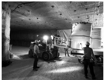
貯蔵室に積み下ろされる廃棄物容器
