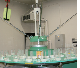
個人線量計の校正などに使用する2π線照射装置
