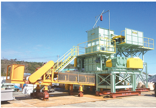
大型破袋機(II写真)を、中間貯蔵施設では一時間当たり百八立方メートルに相当する大型土のう袋などを破り、破いて内容物を取り出す
