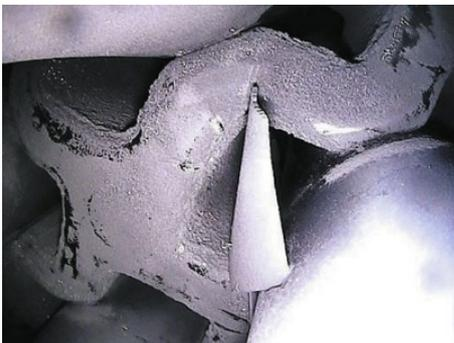
高浜原発4号機の蒸気発生器内の配管(右下)に刺さった鉄さびの薄片(中央の三角形)=福井県で(関西電力提供)
